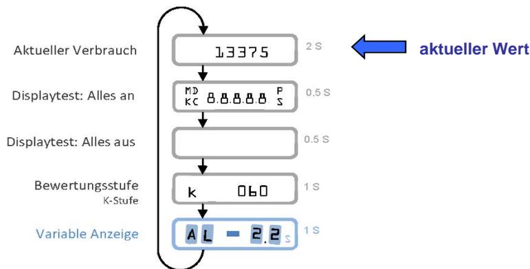
Auf dem Formular sind jeweils die **Gerätenummer** sowie der **aktuelle Wert** der Heizkostenverteiler einzutragen.
